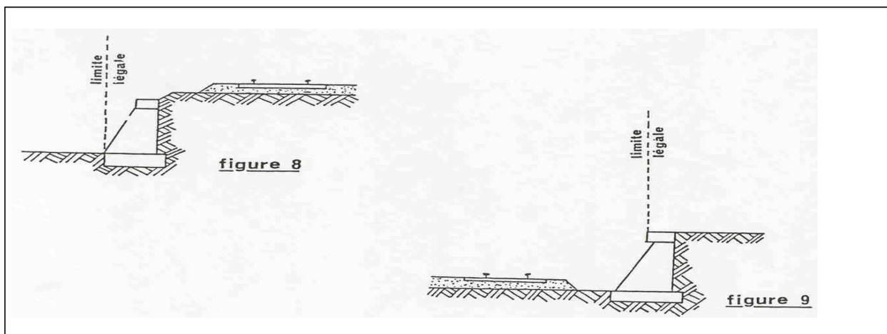
Lorsque le chemin de fer est établi en remblai et que le talus a été rechargé ou modifié par suite d'apport de terre ou d'épuration de ballast, la limite légale pourra être déterminée à partir du pied du talus primitif, à moins toutefois, que cet élargissement de plate-forme ne soit destiné à l'établissement prochain de nouvelles voies.
